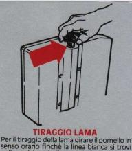
nella posizione indicata dalla freccia BANDSAW BLADE To pull the blade, turn the knob clook-wise until the white line is in the position indica-
