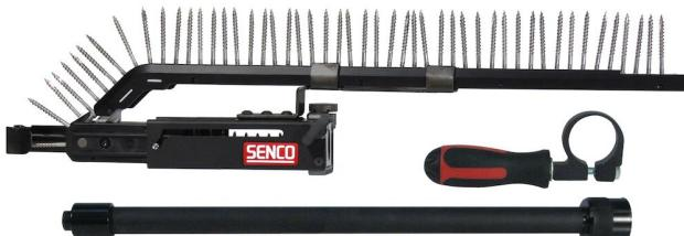
Le DS75 est un système adaptateur de vissage avec système d'alimentation pour pièces d'angle en instance de brevet. Il nécessite un montage sur une visseuse. Capable de visser des vis d'un diamètre de 3,5 à 4,8 mm et d'une longueur de 25 à 75 mm. Livré complet avec extension et poignée réglable pour le vissage de vis en position debout.
