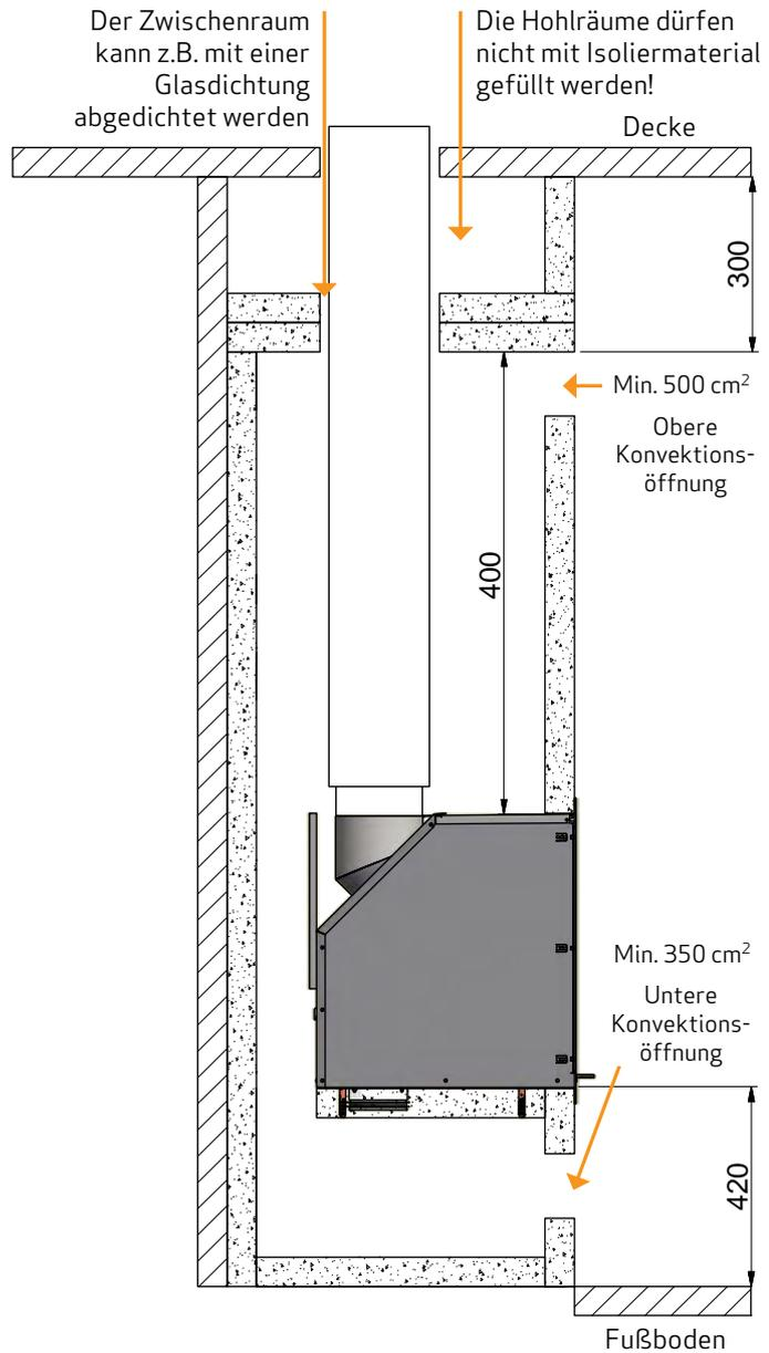
Der Abstand zur Brennmauer (Ziegel) ist davon abhängig, dass ein isoliertes Rauchrohr den ganzen Weg zum Kamineinsatz verwendet wird
