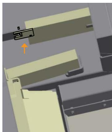
Die Halterung für Rauchumlenkung Nr. 6 auf die Kante der Platten Nr. 3a und 3b platzieren, und danach die untere Umlenkung Nr. 5 montieren. Aufpassen, dass die beiden Rauchumlenkungen gleich liegen
