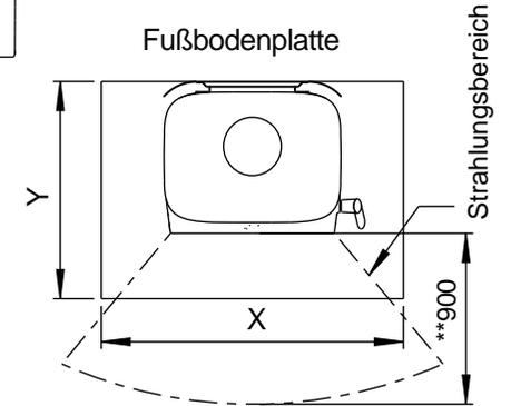
Minimale Abmessungen der Fußbodenplatte / X/Y = Gemäß den geltenden nationalen Gesetzen und Regelungen
