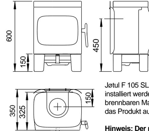
Jøtul F 105 SL (mit kurzen Beinen) kann nur auf Böden installiert werden, deren Oberfläche und Struktur aus nicht brennbaren Materialien bestehen. Dies gilt ebenfalls, wenn das Produkt auf einer Fußbodenplatte ruht.
