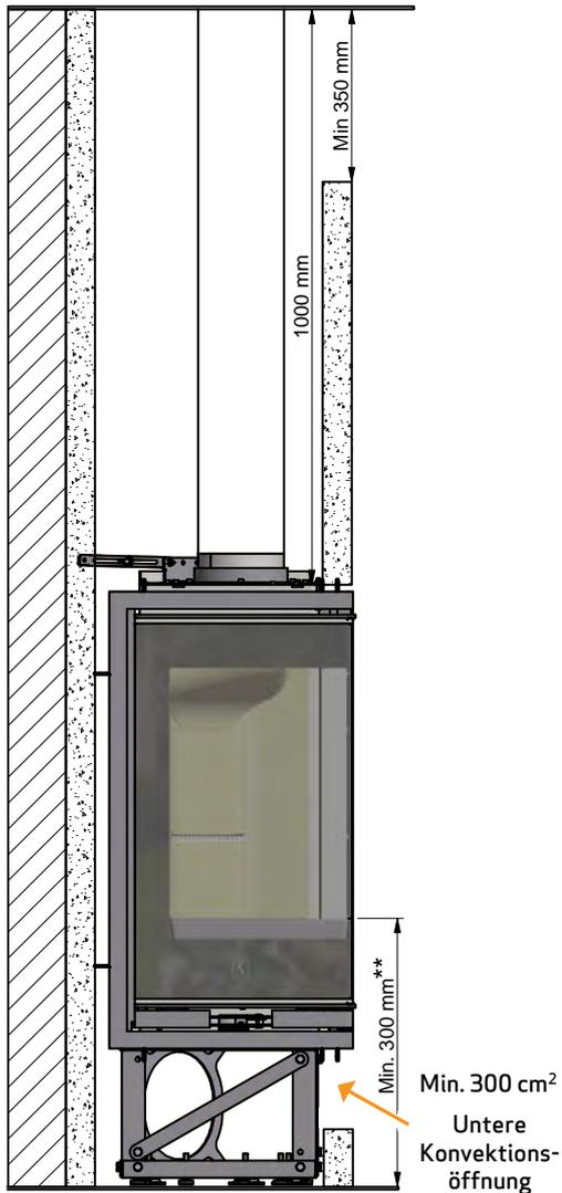
**Aufstellung mit isoliertem, senkrechtem Rauchrohr**
