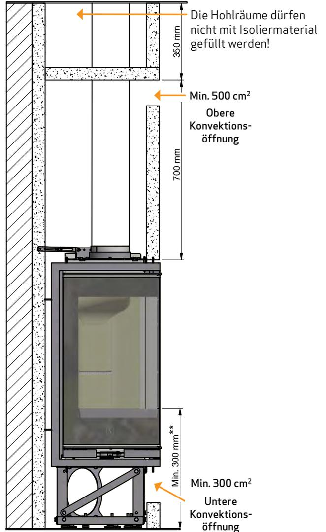
Der Abstand zur Brennmauer (Ziegel) ist davon abhängig, dass ein isoliertes Rauchrohr den ganzen Weg zum Kamineinsatz verwendet wird
