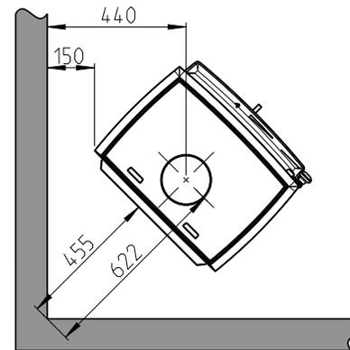
Min. Abmessungen der Fußbodenplatte
