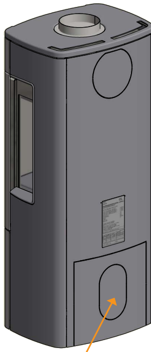
Dekkplaten som fjernes
