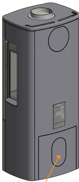
Dekkplaten som fjernes
