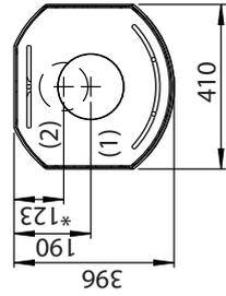
Minimale Abmessungen der Fußbodenplatte
