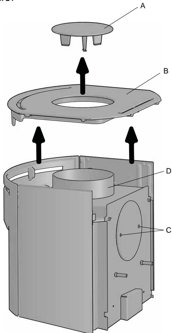
7. Heben Sie die obere Abdeckung (A) sowie die Deckplatte (B) ab und legen Sie sie auf eine Seite.
