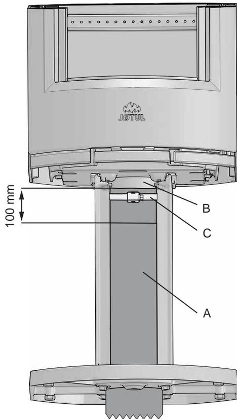
1. Entfernen Sie die Abdeckung **(A)** auf der Sockelvorderseite, indem Sie sie nach oben und vorn heben. Legen Sie sie auf eine Seite **(siehe Abb. 14)**.
