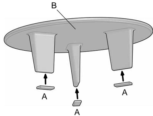
6. Schneiden Sie die mitgelieferte Dichtung (A) in drei Längen, die zu den Laschen passen. Positionieren Sie die Dichtungen an den Enden der drei Laschen an der oberen Abdeckung (B).
