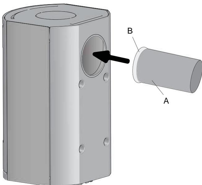
14. Bringen Sie die Dichtung (B) am Rand des Rauchgasrohrs (A) an.
