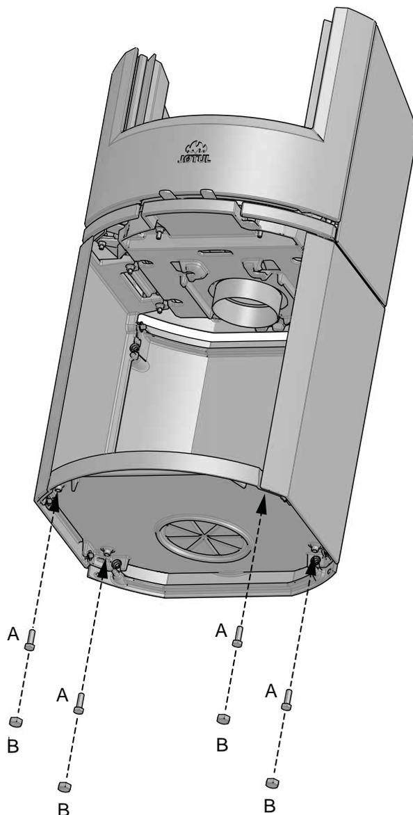
6. Befestigen Sie die Höheneinstellschrauben (A), die sich zusammen mit den Kunststoffkappen (B) im Schraubenbeutel befinden. **Hinweis: Bei Verwendung der optionalen Fußbodenglasplatte (Zusatzausstattung) muss der Kaminofen ca. 8 mm vom Boden angehoben werden, damit die Fußbodenplatte unter den vorderen Sockelerand geschoben werden kann.**
