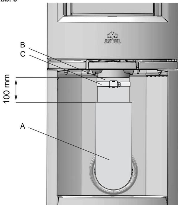
2. Um den  $\varnothing$  100-mm-Außenluftschlauch (A) zu befestigen (optionale Anbringung: Art.nr. 51012164), richten Sie sich nach dem Handbuch (10026187), das dem Außenluftsatz beiliegt. Bringen Sie den Schlauch am Außenluftanschluss (B) per Schlauchklemme (C) an. Schließen Sie die Isolierung ca. 100 mm unterhalb der Brennkammer ab.
