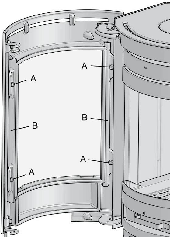
1. Entfernen Sie die vier Schrauben (**A**), die die Halterungen (**B**) an der Tür befestigen.
