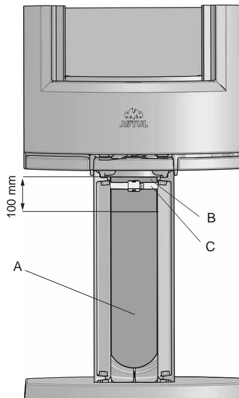
4. Um den  $\varnothing$  100-mm-Außenluftschlauch (A) zu befestigen (optionale Anbringung: Art.nr. 51012164), richten Sie sich nach dem Handbuch (10026187), das dem Außenluftsatz beiliegt. Bringen Sie den Schlauch am Außenluftanschluss (B) per Schlauchklemme (C) an. Schließen Sie die Isolierung ca. 100 mm unterhalb der Brennkammer ab.
