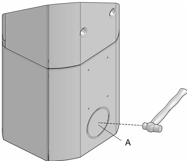
1. Soll eine Außenluftzufuhr per flexiblem Schlauch ( $\varnothing$  100 mm) zum Außenluftanschluss unterhalb der Brennkammer hergestellt werden, schlagen Sie zuerst die abnehmbare Abdeckplatte (A) heraus.
