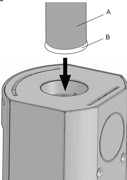
2. Bringen Sie die Dichtung (B) am Rand des Rauchgasrohrs (A) an.
