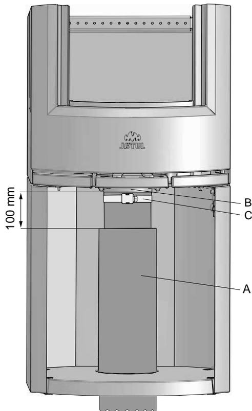
3. Um den Ø 100-mm-Außenluftschlauch (**A**) zu befestigen (optionale Anbringung: Art.nr. 51012164), richten Sie sich nach dem Handbuch (10026187), das dem Außenluftsatz beiliegt. Bringen Sie den Schlauch am Außenluftanschluss (**B**) per Schlauchklemme (**C**) an. Schließen Sie die Isolierung ca. 100 mm unterhalb der Brennkammer ab.
