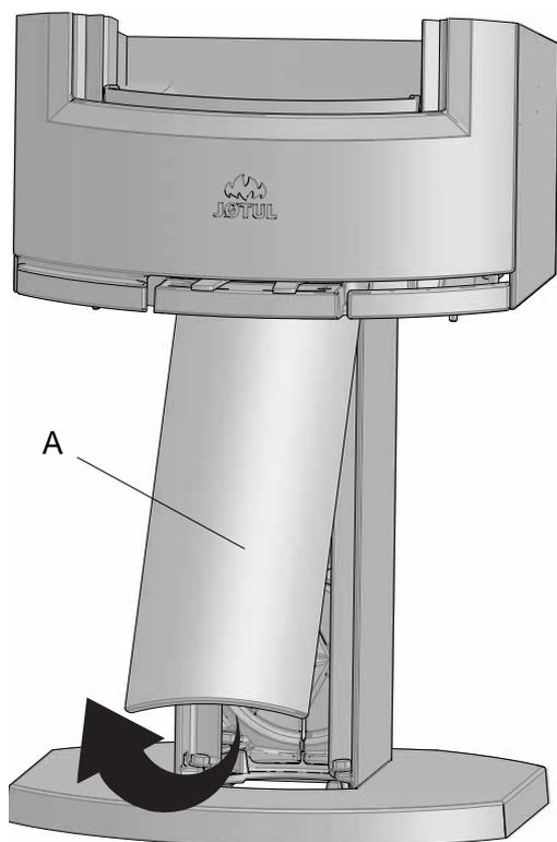
3. Entfernen Sie die Abdeckung (A) auf der Sockelvorderseite, indem Sie sie nach oben und vorn heben. Legen Sie sie auf eine Seite.
