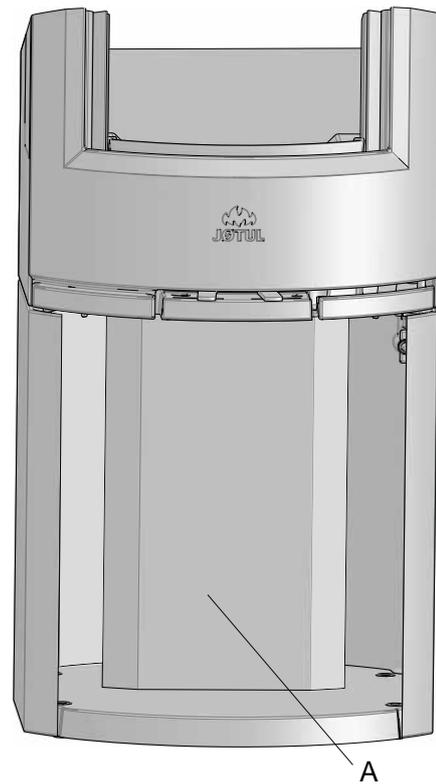
3. Bringen Sie die mitgelieferte Platte (A) an, um den Außenluftschlauch zu kaschieren.
