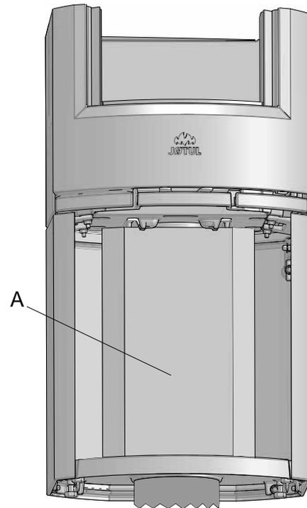
4. Bringen Sie die mitgelieferte Platte (**A**) an, um den Außenluftschlauch zu kaschieren.
