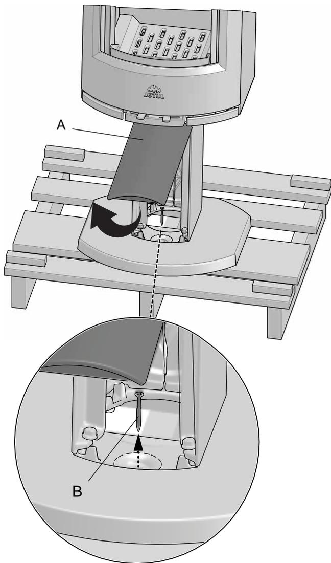
1. Heben Sie die vordere Abdeckung (A) am Sockel nach oben sowie nach vorn und legen Sie sie auf eine Seite.
