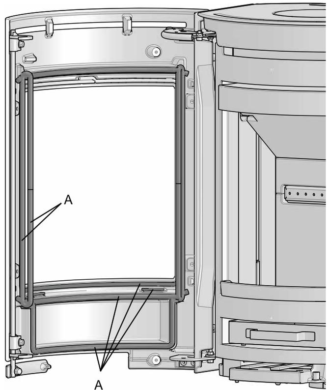
4. Entfernen Sie die Dichtungen (**A**) von der Tür. Reinigen Sie die Dichtungsnut gründlich und kleben Sie neue Dichtungen ein.
