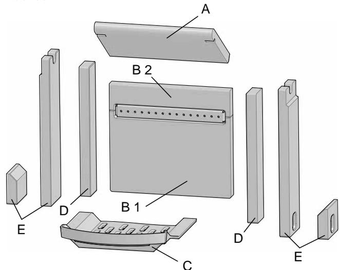
1. Leitblech: Heben Sie den hinteren Rand des Leitblechs (A) nach oben und unten. Drehen Sie es aus der Brennkammer heraus.
