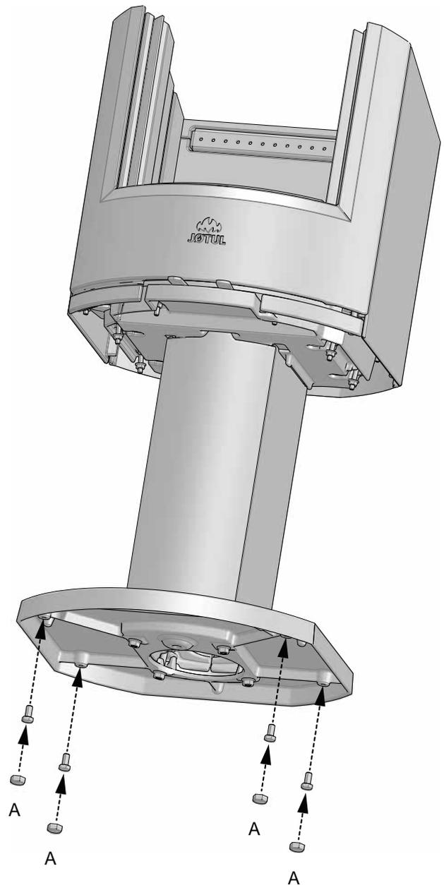
5. Verschrauben Sie die Höheneinstellschrauben (A) mit den Kunststoffkappen (B) aus dem Schraubenbeutel. **Hinweis: Bei Verwendung der optionalen Fußbodenglasplatte muss der Kaminofen ca. 8 mm vom Boden angehoben werden, damit die Fußbodenplatte unter den vorderen Säulrand geschoben werden kann.**
