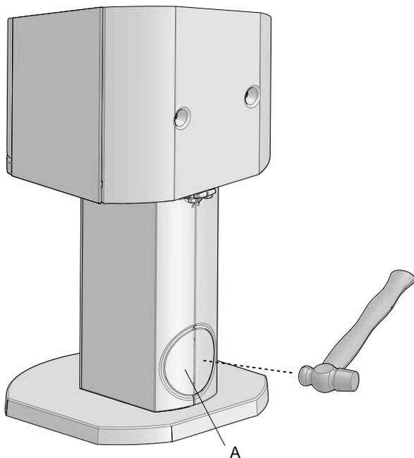
1. Klopfen Sie die hintere Abdeckung (A) im Sockel mit einem Hammer heraus.
