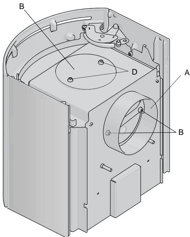
10. Befestigen Sie den Rauchabzug (A) am rückseitigen Abzug und verschrauben Sie ihn mit denselben Schrauben (B), mit denen er befestigt war.
