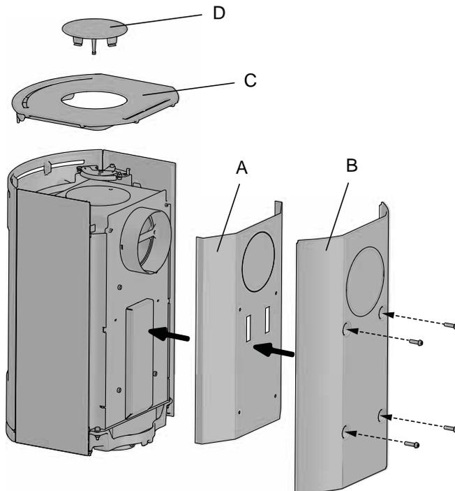
12. Positionieren Sie die innere (A) und äußere (B) rückseitige Platte an der Brennkammer an und befestigen Sie diese mithilfe derselben 4 Schrauben, mit denen sie angebracht waren.
