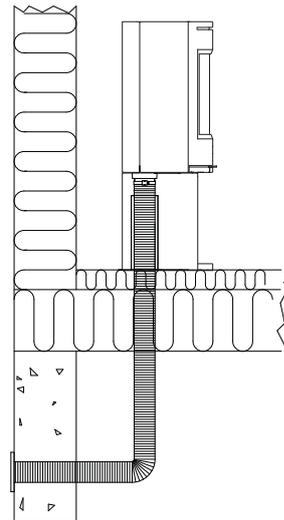
**Abb. 2D**, indirekt durch eine Außenwand
