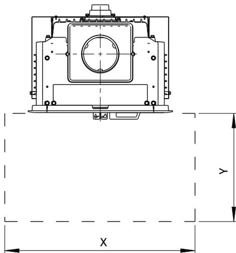
Minimale Abmessungen der Fußbodenplatte X,Y =
