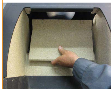
Øverste hvelv settes inn med utskjæring opp 15
