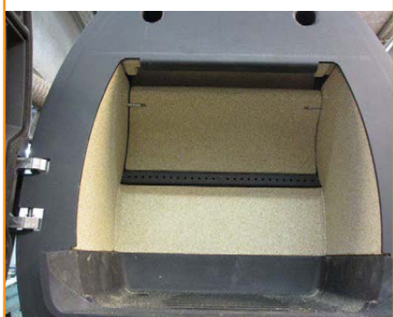
Brennkammeret er nå montert 22
