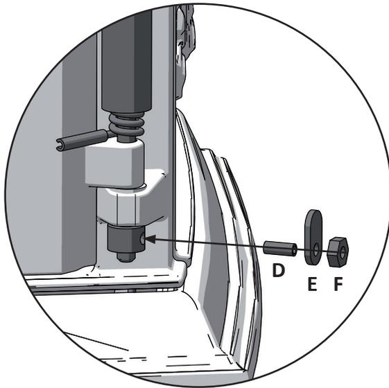
*Drehe die Stellschraube D ein. Setze die Sperrscheibe E auf und schraube anschließend die Mutter F darauf. Die Sperrscheibe sollte nach oben zeigen und nach dem Festziehen am Scharnier anliegen.*
