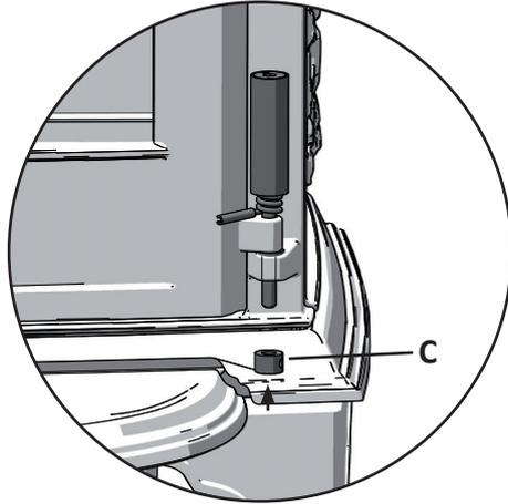
*Schiebe den Spannring C auf die Achse unterhalb der Scharniere.*
