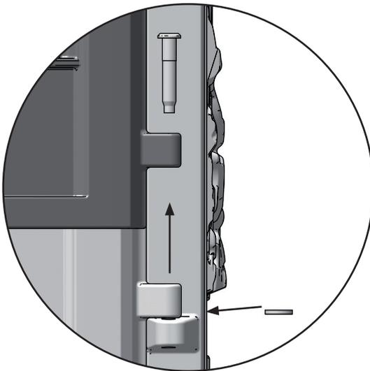
Hebe die Tür an und ziehe den Stift heraus, der die unteren Scharniere miteinander verbindet. Stelle sicher, dass die Scheibe zwischen den Scharnieren nicht verloren geht.
