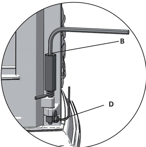
*Um die Feder zu spannen, muss ein 5mm Inbusschlüssel oben am Federbolzen B und ein 2mm Inbusschlüssel an der Stellschraube D angesetzt werden.*
