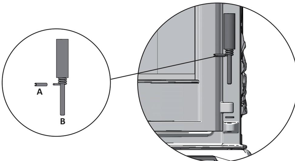
Setze den Spannstift A auf das Federende und platziere den Federbolzen B im Scharnier, achte auf die Unterlegscheibe.
