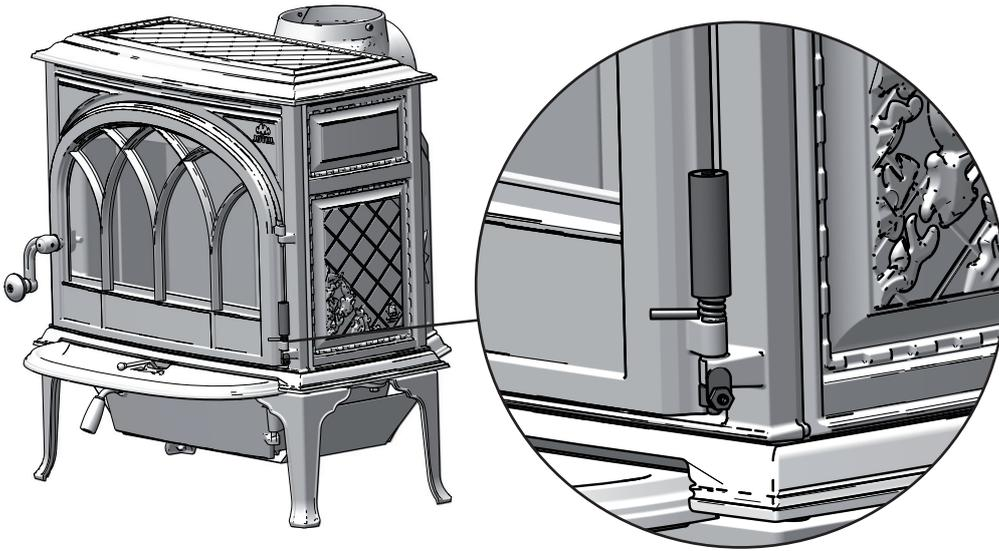
Das Bild zeigt den selbstschließenden Türmechanismus fertig montiert.
