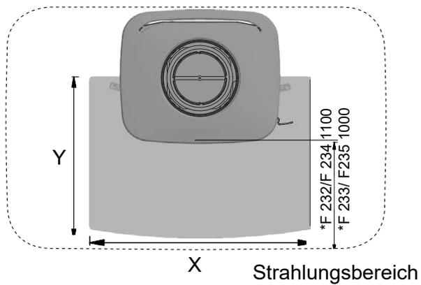
Minimale Abmessungen der Fußbodenplatte
