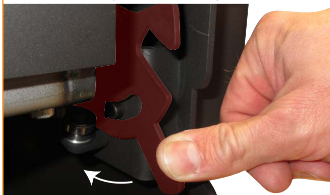
Nach unten drücken, um den Schließmechanismus wieder in der richtigen Position zu bringen
