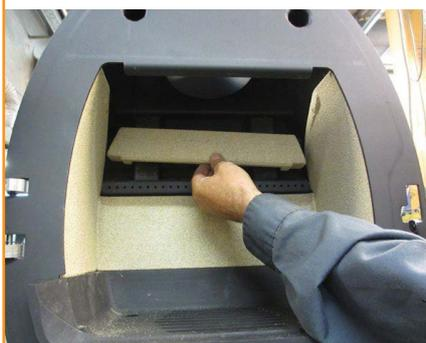
Die Platte über die Seitenplatten heben
