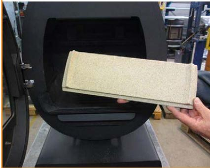
Die platte hinter den Rost gleiten lassen
