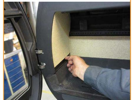
Linke Seitenplatte montiert
