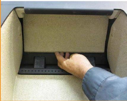
Nach hinten drücken, damit die Platte auf der hintere Schiene liegt
