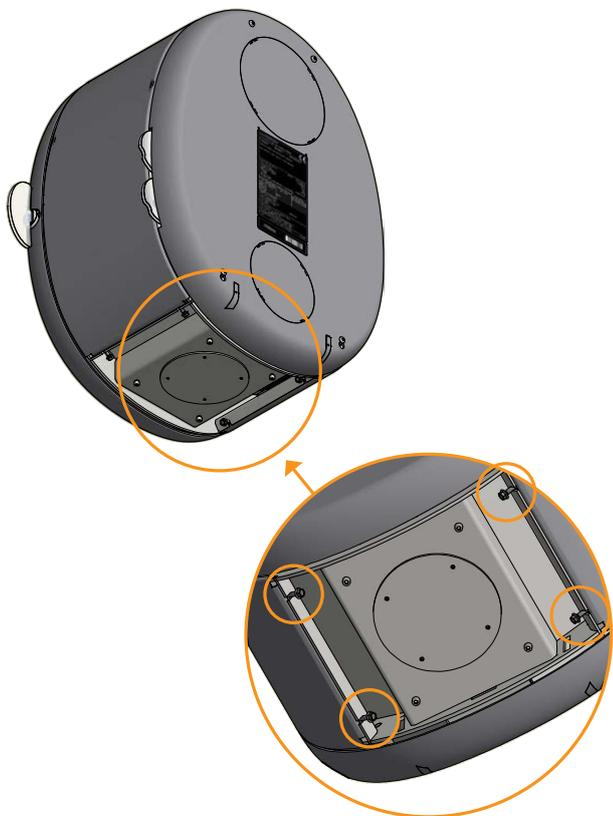
Den Anschlußstutzen mit den Schrauben befestigen
