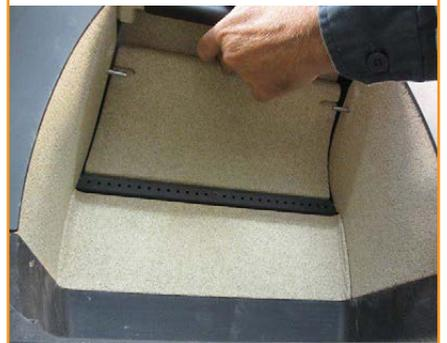
Die Brennkammerplatten sind jetzt montiert
