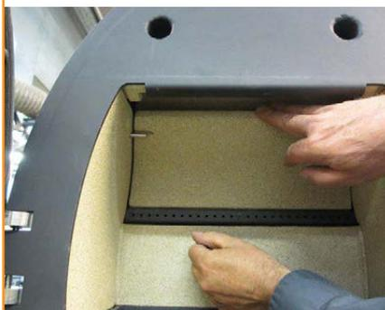
Stifte in den Seitenplatten montieren
