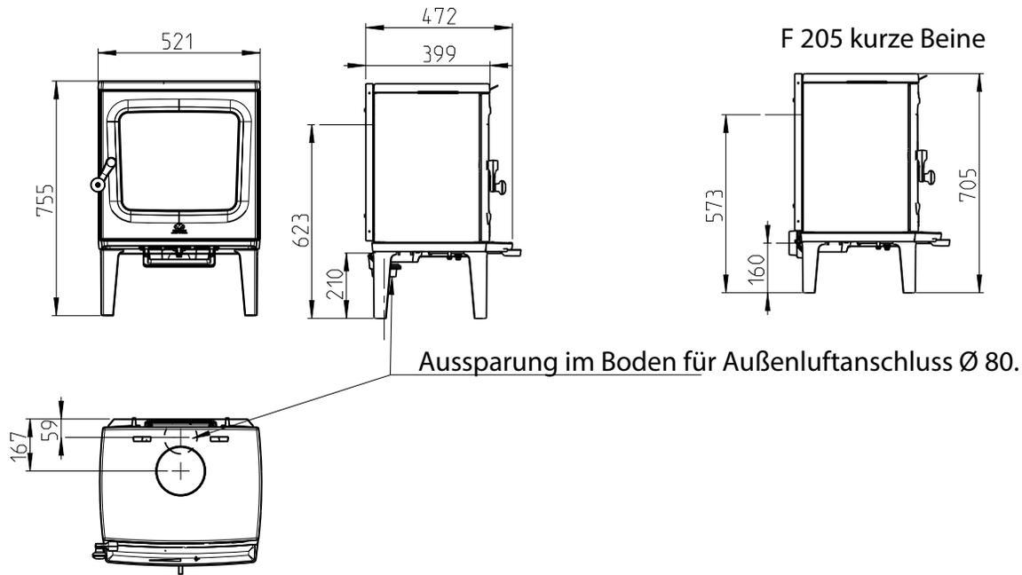
Ausparung im Boden für Außenluftanschluss Ø 80.
