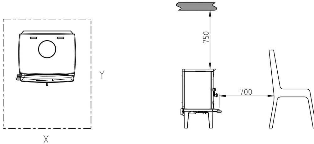
Min. Abmessungen der Fußbodenplatte
