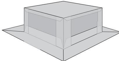
3. Så skjærer man hull for pipemodulet når man skal montere, da med en minimumavstand på 50 mm rundt det hele.
