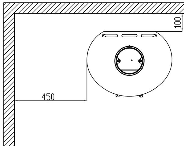
Abstand zu Brandschutzmauer, mit isoliertem Rauchrohr
