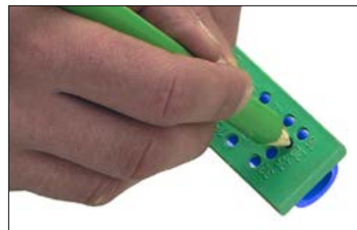
Markering av fusjonsdybde
