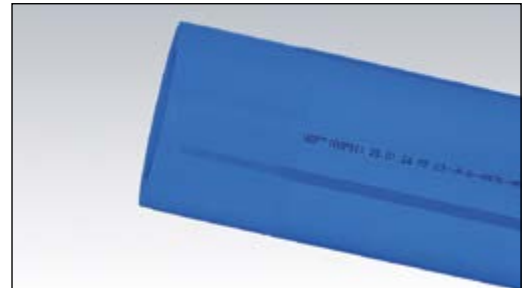
Kuttet, skrapet og rengjort - klart for sveising
