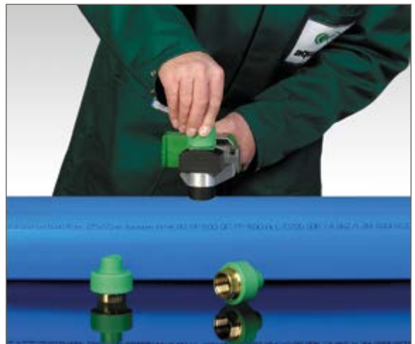
Oppvarming av rør og rørdel
