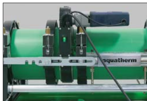
Rørendene høvles plane.
