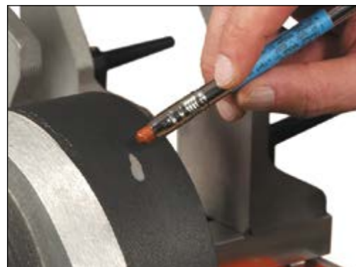
Temperaturkontroll med temperaturpenn
