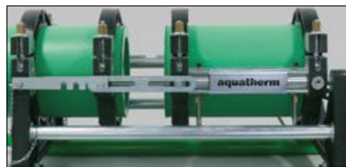
Separer maskinsleidene og fjern varmesverdet.
