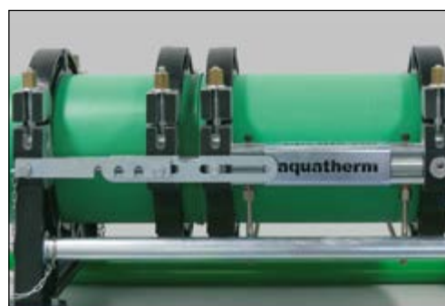
Trekk sammen rørene. Avkjøles under trykk.
