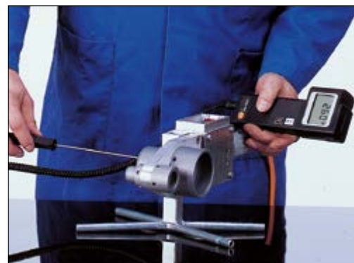
Temperaturkontroll med måleinstrument
