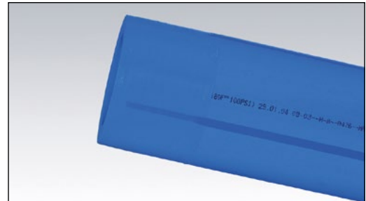
Kuttet, skrapet og rengjort - klart for sveising
