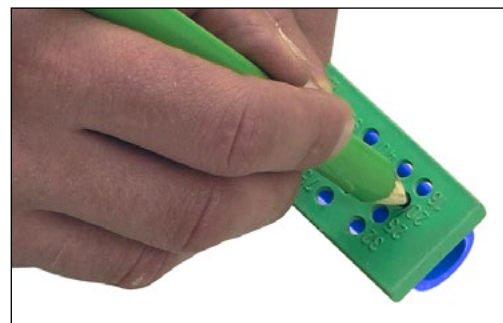
Markering av fusjonsdybde
