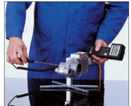
Temperaturkontroll med måleinstrument
