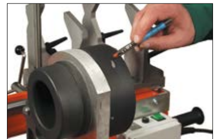
Temperaturkontroll med temperaturpenn
