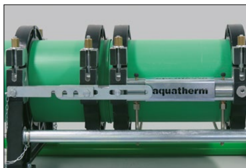
Trekk sammen rørene. Avkjøles under trykk.
