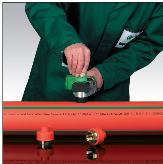
Oppvarming av rør og rørdel
