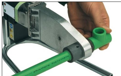
Oppvarming av rør og rørdel
