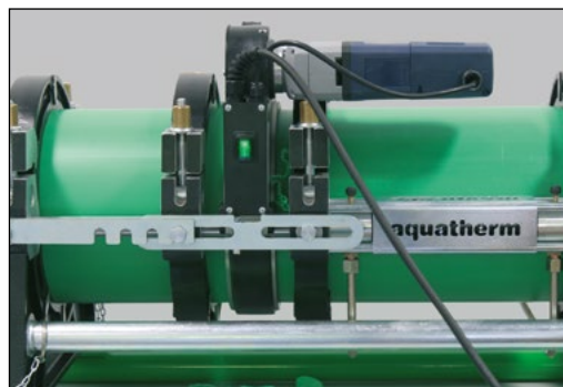
Rørendene høvles plane.
