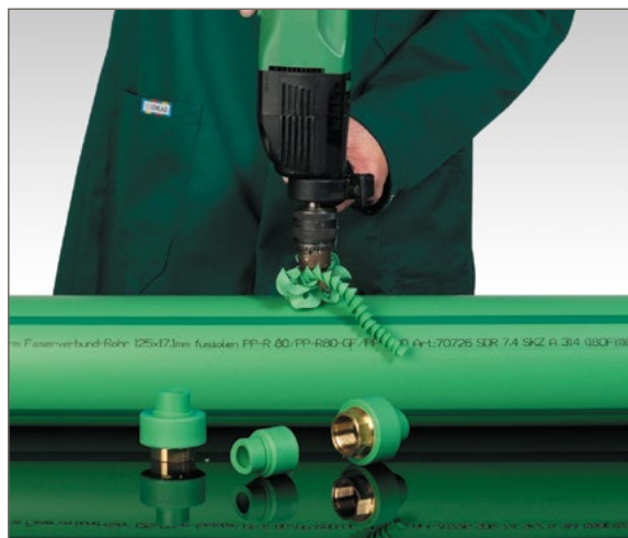
Gjennom boring av rørveggen
