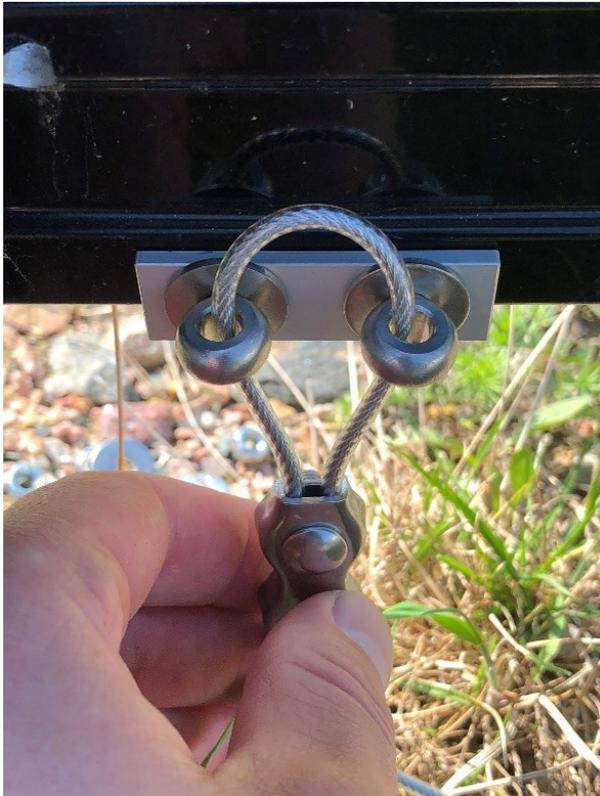
4. Sichern Sie die Augenschrauben von der Vorderseite mit Unterlegscheiben und Sicherungsmuttern.
