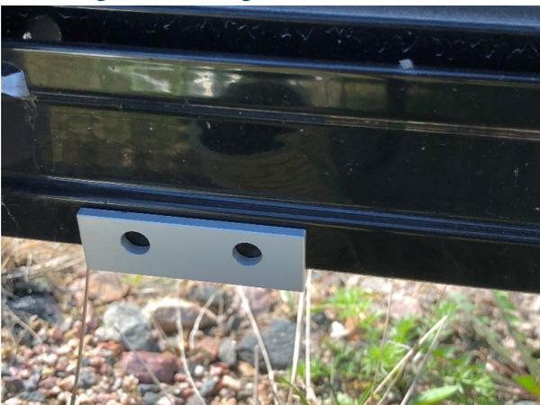
5. Bohren Sie die parallelen Löcher nacheinander durch die Vorder- und Rückseite des Rahmenprofils. Die Löcher der Halterung dienen dabei als Führung.
