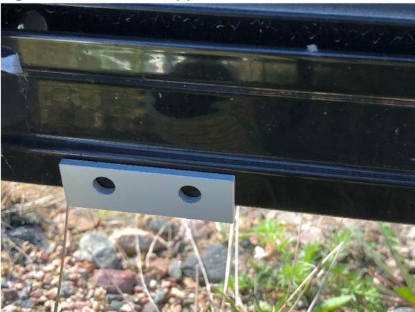
3. À l'arrière, montez les deux boulons à œil avec une rondelle entre le boulon à œil et le support.
