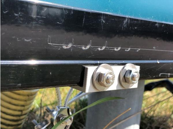
8. Serrez doucement les contre-écrous à l'aide d'une clé en gardant le boulon à œil fixe.
