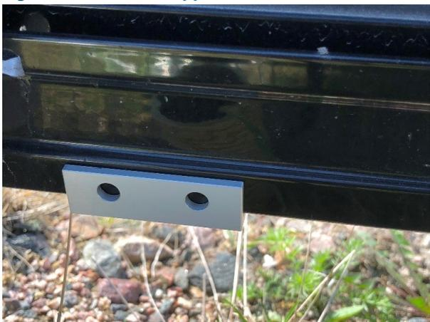
5. Percez des trous parallèles, d'un côté puis de l'autre, à l'avant et à l'arrière du profil inférieur en vous servant des trous du support pour vous guider.
