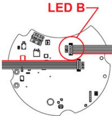
Abbildung 23: Konverter mit 2 Anschlüssen
