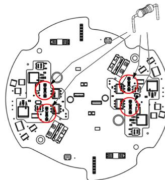
3. Ziehen Sie die Sicherungswiderstände vom Konverter ab.
