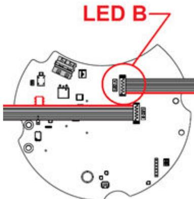
**Abbildung 11: Konverter mit 2 Anschlüssen**
