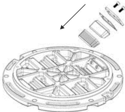
4. Überprüfen Sie, dass der O-Ring der Prismendichtung im abgeschrägten Bereich gleichmäßig anliegt.
