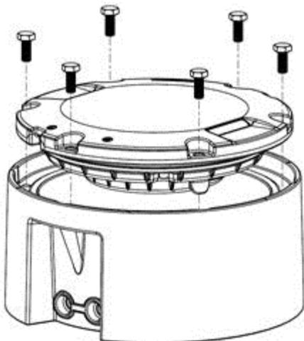
1. Alle Kontaktflächen des Feuers und des Einbaugehäuses sorgfältig säubern.
