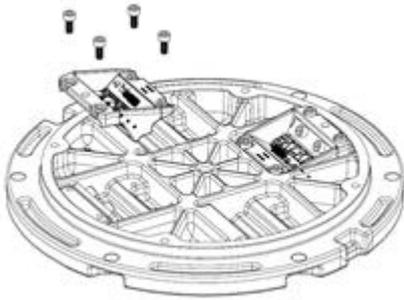
**Abbildung 18: Prisma samt Dichtung entnehmen**
