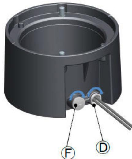
Flache Einbautöpfe mit Zugang von der Seite werden mit zwei Gewindebohrungen geliefert. Flache Einbautöpfe mit nur einem Steckverbinder erfordern ein zweites Loch, das mit einer Abdeckkappe verschlossen werden muss.
