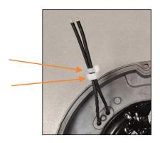
5. Unscrew the Cord-set-retainer Disc Bolt.
