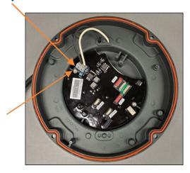
3. 4. Unscrew the Cord-set-retainer Disc Bolt.
