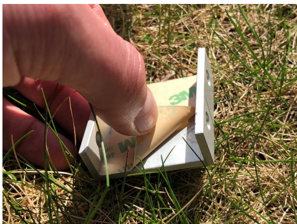
Rysunek 12: Usunięcie warstwy ochronnej
