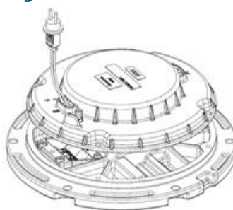
Figure 8 : Soulevez le boîtier
