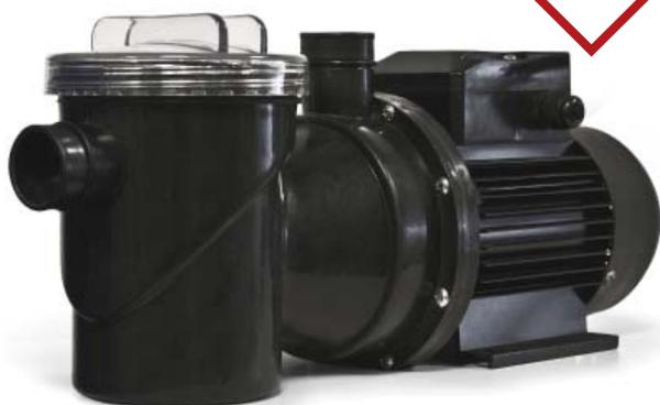
Les pompes, centrifuges, sont fournies avec des moteurs monophasés, de 150 W, 340 W, 490 W, 600 W, 640 W, 790 W et 1030 W. Le corps de la pompe, en thermoplastiques de toute dernière génération, incorpore un préfiltre qui permet d'éviter la pénétration de corps étrangers et l'endommagent des parties hydrauliques de la pompe.
