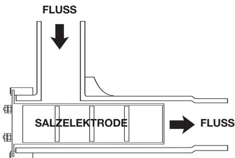
Für den einwandfreien Betrieb der Elektrolysezelle wird empfohlen, das Heizungssystem nicht weiter als 20 m vom Pool entfernt anzuordnen (40 m Rohrleitung hin/zurück). Darüber hinaus empfehlen wir, oberhalb des Heizungssystems eine Zwischenpumpe zu installieren.
