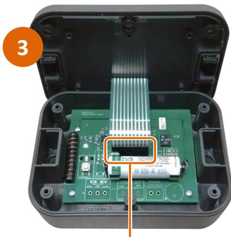
O comando à distância necessita de uma alimentação contínua de 3,6 V através de uma bateria de lítio, modelo LS14500 da marca SAFT.
