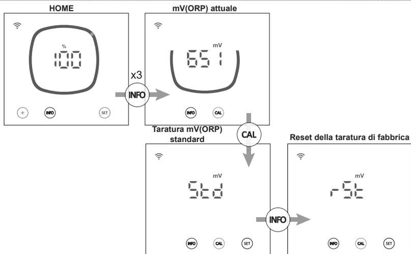
Dal menu di taratura mV(ORP), l'apparecchiatura consente di eseguire una taratura standard o di resettare la taratura attuale ai valori di fabbrica:
