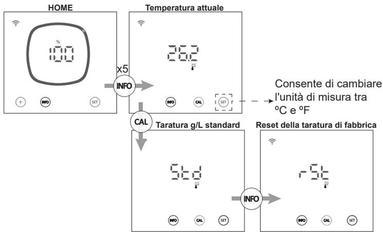
Dal menu di taratura della temperatura, l'apparecchiatura consente di eseguire una taratura standard o di resettare la taratura attuale ai valori di fabbrica:
