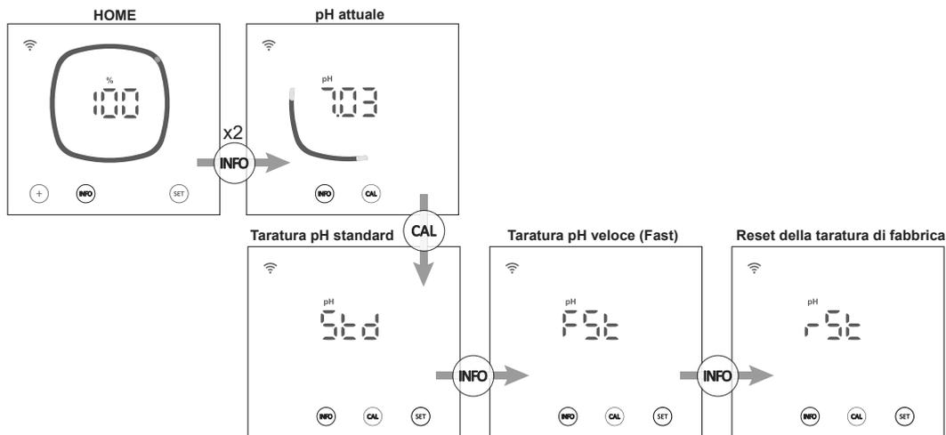
Dal menu di taratura del pH, l'apparecchiatura consente di eseguire una taratura standard, una taratura veloce (Fast) o di resettare la taratura attuale ai valori di fabbrica:
