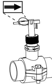
Se l'FS è attivo e il sistema non rileva alcun flusso d'acqua, l'apparecchiatura emetterà un allarme FS e la produzione di elettrolisi si arresterà istantaneamente.
