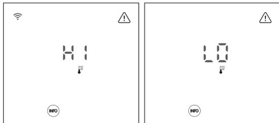
L'allarme di temperatura appare quando i valori di temperatura non rientrano nell'intervallo configurato dall'utente.
