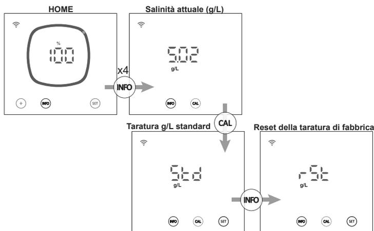
Dal menu di taratura della salinità, l'apparecchiatura consente di eseguire una taratura standard o di resettare la taratura attuale ai valori di fabbrica:
