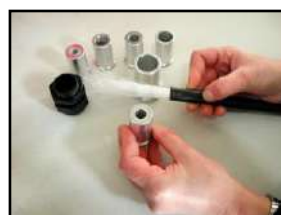
3. Choisir le réducteur nécessaire en fonction de la quantité de fibres.
