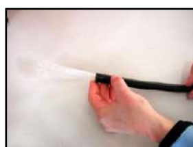
2. Vérifier que les fibres ne sont pas abîmées.
