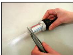
9. Apoiando a lâmina na porta, corte as fibras que sobressaírem.
