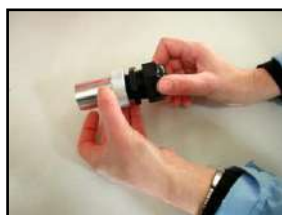
5. Avvitare il premistoppa al porta fibre
