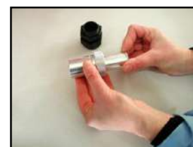
4. Introduire le réducteur dans le corps du port optique.
