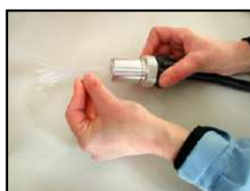
7. Tenir fermement les fibres avec le presse-étoupe et introduire des morceaux de fibre jusqu'à ce qu'il ne reste plus d'espaces vides.
