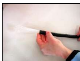
2. Verificare che le fibre non siano state danneggiate
