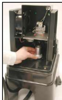
11. Introduza a porta óptica pelas aberturas situadas na base do gerador e fixe-a à pinça.
