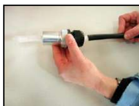
6. Introdurre le fibre fino a che fuoriescano TUTTE dalla testa del porta fibre
