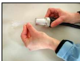
7. Sostenere le fibre con il premistoppa e introdurre pezzi di fibra fino a quando non siano rimasti spazi vuoti
