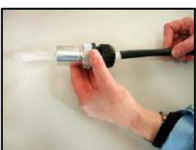
6. Introduire les fibres dans le port optique jusqu'à ce qu'elles sortent TOUTES de la tête du port.
