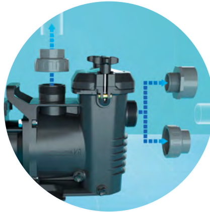
Filettatura interna 1"1/2. Filettatura esterna 2" 1/4 per semi-bocchettonediametro 50mm
