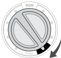
2. Después de programar, coloque el selector en la posición **AUTOMÁTICO** para activar la ejecución automática de todos los programas y horas de arranque seleccionados.
