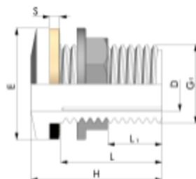
ADAPTADOR PARA DEPÓSITO con extremo roscado macho G1 con collar de sujeción y junta plana de EPDM\* y junta plana\* junta gruesa para compensar las ondulaciones en las paredes del recipiente, plástico, espesor 4-6 mm; o espacio fordeformado al fijar a la pared redonda del tanque
