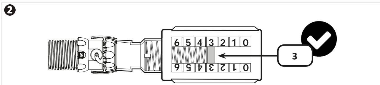
Se necessario, utilizzare le valvole della piscina per regolare la portata di modo che la spia sia sulla posizione 3.
