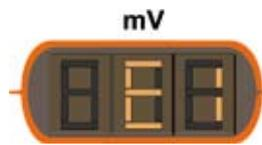
Wenn der Kalibrierungsprozess aus irgendwelchen Gründen unterbrocht wird, so stellt sich der Regler automatisch vom Kalibriermodus auf den Normalmodus um, wenn der Benutzer nicht nach wenigen Sekunden eingreift. In diesem Fall zeigt das obere Display [20] während einigen Sekunden „E1“ an.
