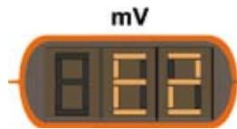
Wenn der während der Kalibrierung gemessene ORP-Wert sehr von dem erwarteten Wert abweicht (z.B. beschädigte Sensor, usw.), so wird im oberem Display [20] „E2“ angezeigt, ohne dass eine Kalibrierung der Sensor möglich ist.
