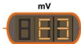
Wenn der ORP-Wert während dem Kalibrierungsprozess schwankend ist, so wird so wird der Code „E3“ angezeigt. Auch hier kann die Sensor nicht kalibriert werden
