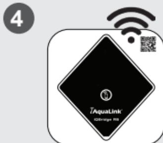
4 Свържете продукта с Вашата Wi-Fi мрежа. Светодиодът за Bluetooth се изключва, а светодиодът за Wi-Fi става постоянно син, след като шлюзът е свързан с Wi-Fi.
