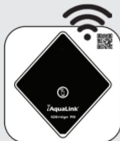
Ürünü Wi-Fi ağınıza bağlayın. Ağ geçidi Wi-Fi'ye bağlandığında Bluetooth LED'i kapanır ve Wi-Fi LED'i sabit mavi olur.
