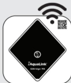
Tilslut produktet til dit wifi-netværk Bluetooth LED'en slukker, og wifi-LED'en lyser konstant blå, når gatewayen er sluttet til wifi.
