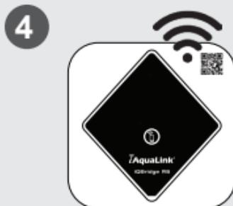
4 Csatlakoztassa a terméket az Ön Wi-Fi hálózatához. Amikor az átjáró csatlakozott a Wi-Fi-hez, a Bluetooth LED kialszik, és a Wi-Fi LED elkezd kéken világítani.
