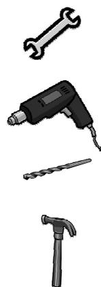
Trapano e punte da cemento Ø 6 et Ø10
