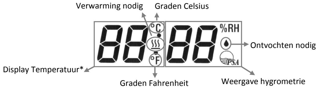
\* alleen als uw apparaat voorzien is van de optie warm water accu, of elektrische bijverwarming.
