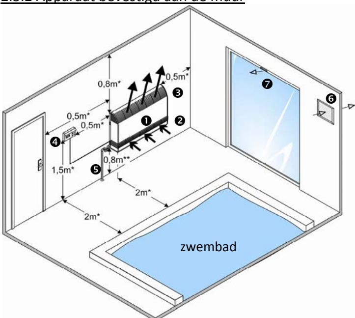
Met behulp van de twee verankeringspunten aan de achterzijde van het apparaat (met twee slotschroeven, ringen en pluggen (meegeleverd) in een "massieve muur").
