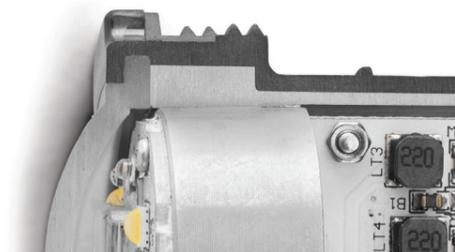
En contact permanent avec l'eau de la piscine, **ils fonctionnent toujours à une température idéale, pour une durée de vie optimale.**
