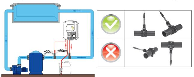
• A injeção de cloro líquido deve ser posicionada antes da injeção de corretor pH e após o sistema de aquecimento.
