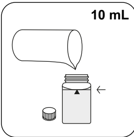
用 10 mL 样本填充 24 mm 密封比色杯。
