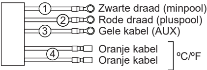
De gasstroomsensor op het apparaat aansluiten.
